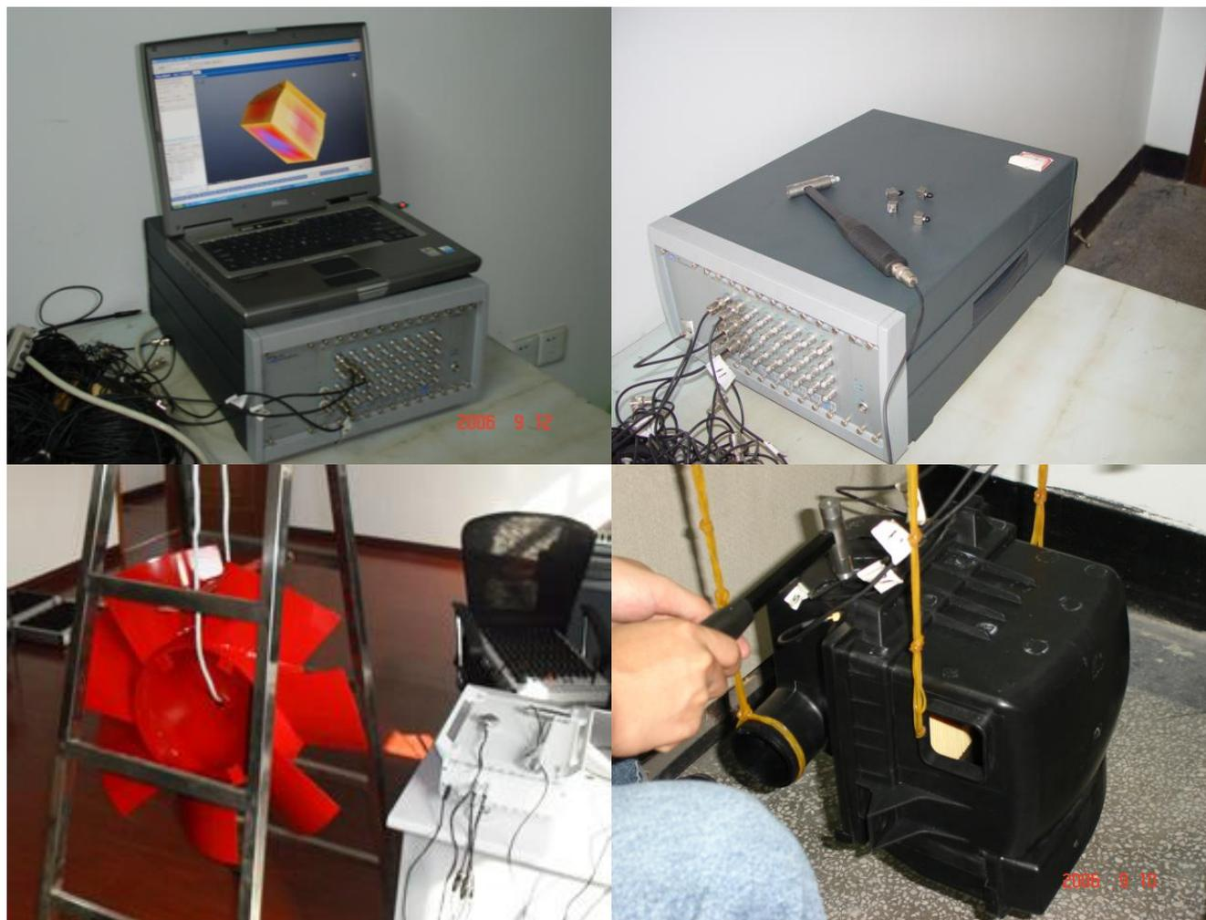
能够对风扇进行单点或多点激励，通过振动传感器测量响应输出，利用软件的频响函数分析模块计算得到各点频响函数数据，从而进行风扇自振模态分析。
